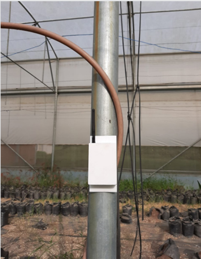
Figura 9. Sensor DHT22 dentro del invernadero.
